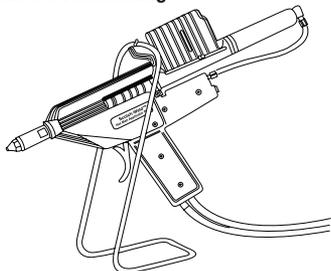
Immer den mitgelieferten Ständer verwenden, wenn die 3M™ Scotch-Weld™-Heißklebepistole PG II nicht verwendet wird. **Legen Sie die Klebepistole nie auf die Seite.** Dies verhindert die Abkühlung und kann zu Verstopfungen führen.
