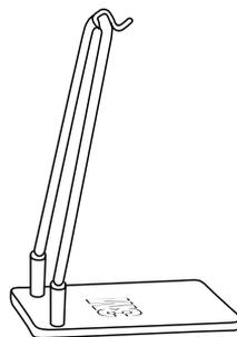
Der robuste Ständer hält die 3M Scotch-Weld-Heißklebepistole PG II in der richtigen Position, wenn sie nicht verwendet wird.
